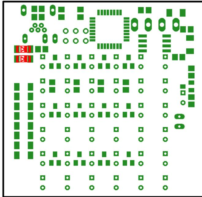
**Einlöten der 10 1N4148 Dioden auf der Unterseite**
