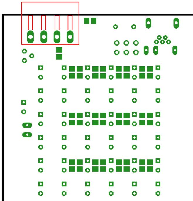
**Einlöten des 78L05 Spannungsreglers auf der Oberseite**
