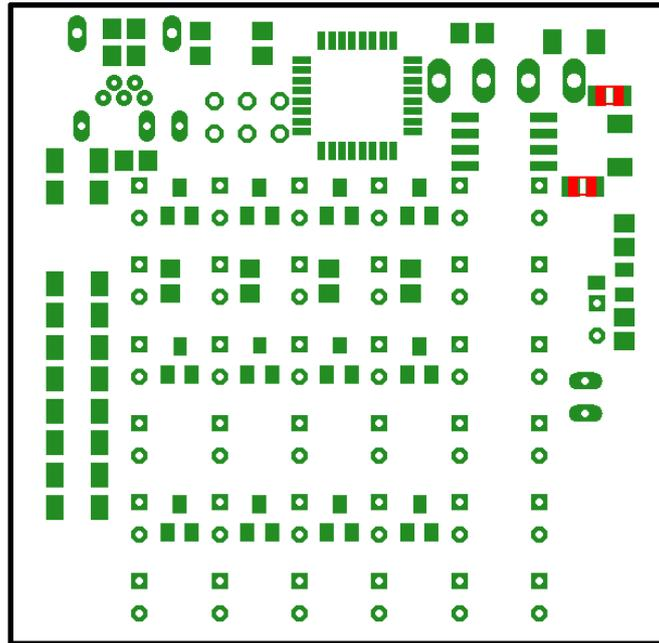
Einlöten der 2 33 pico Farad Kondensatoren auf der Unterseite
