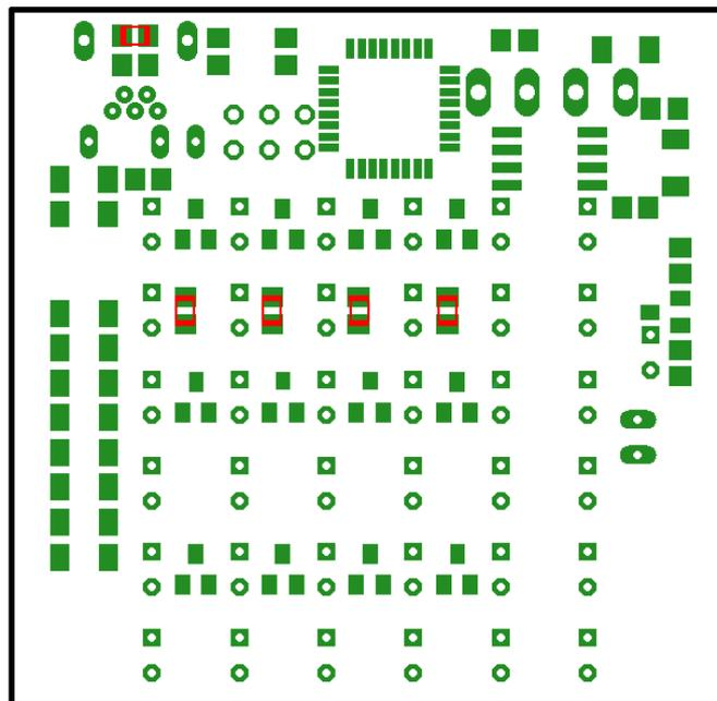
Einlöten der 2 68 Ohm Widerstände auf der Unterseite
