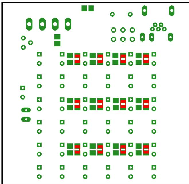
**Einlöten der 2 100 nano Farad Kondensatoren auf der Oberseite**
